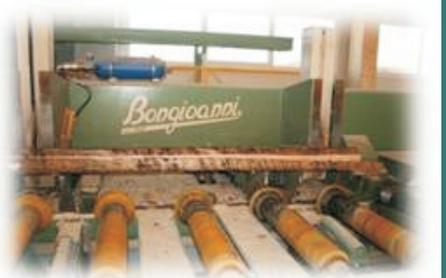
Unsere Sägelinie besteht aus einer doppelten Bandsäge mit Spaner und einer kombinierten Nachschnittsäge. Diese moderne Technologie ermöglicht eine flexible Fertigung einer breiten Produktpalette.
